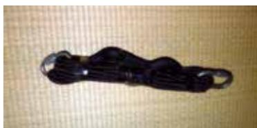
Il existe différents types d'amortisseurs à base d'élastiques. Le principe est un enroulement d'élastiques, sécurisé par une accroche fixe qui joue le rôle de limiteur d'allongement ou de sécurité en cas de rupture. L'amortisseur doit être réglé en fonction du poids spécifique du pratiquant.
