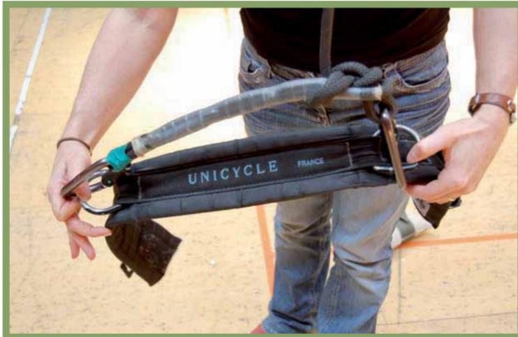
Fig. 2 Mostrando sistema de investida com “dispositivo de segurança” de dupla carabina
